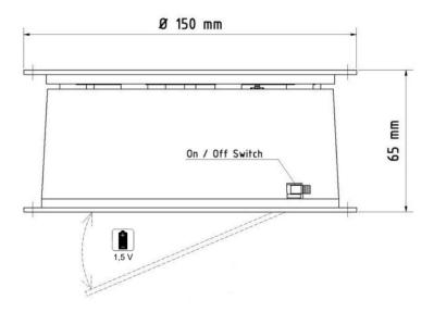
Wegen dem Kunststoffgehäuse und dem Zahnrad ist diese Drehbühne für einen zeitlich begrenzten Gebrauch geeignet (ca. 6 – 12 Monaten). Für eine längere Benützungsperiode empfehlen wir: Drehbühne MAX 10 kg.
