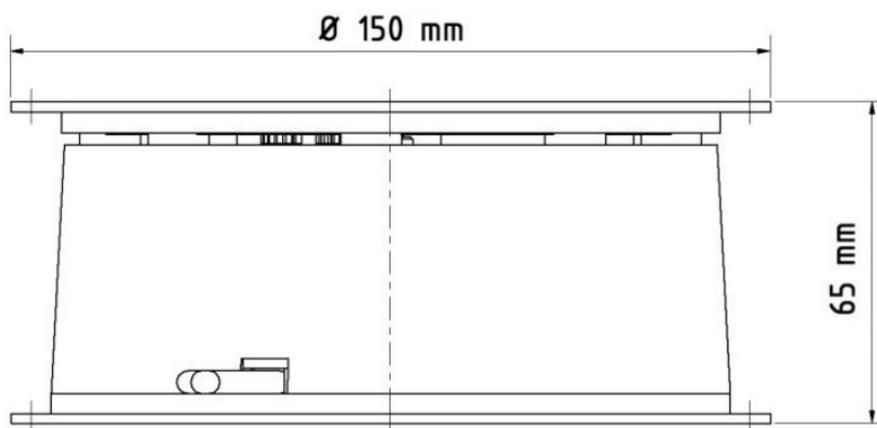
*Wegen dem Kunststoffgehäuse und dem Zahnrad ist diese Drehbühne für einen zeitlich begrenzten Gebrauch geeignet (ca. 6 – 12 Monaten). Für eine längere Benützungperiode empfehlen wir: Drehbühne MAX 10 kg.*
